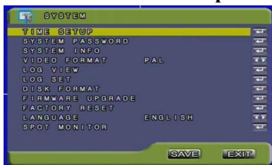
В системных настройках производится настройки системного времени, системного журнала, системного пароля и т.д.
